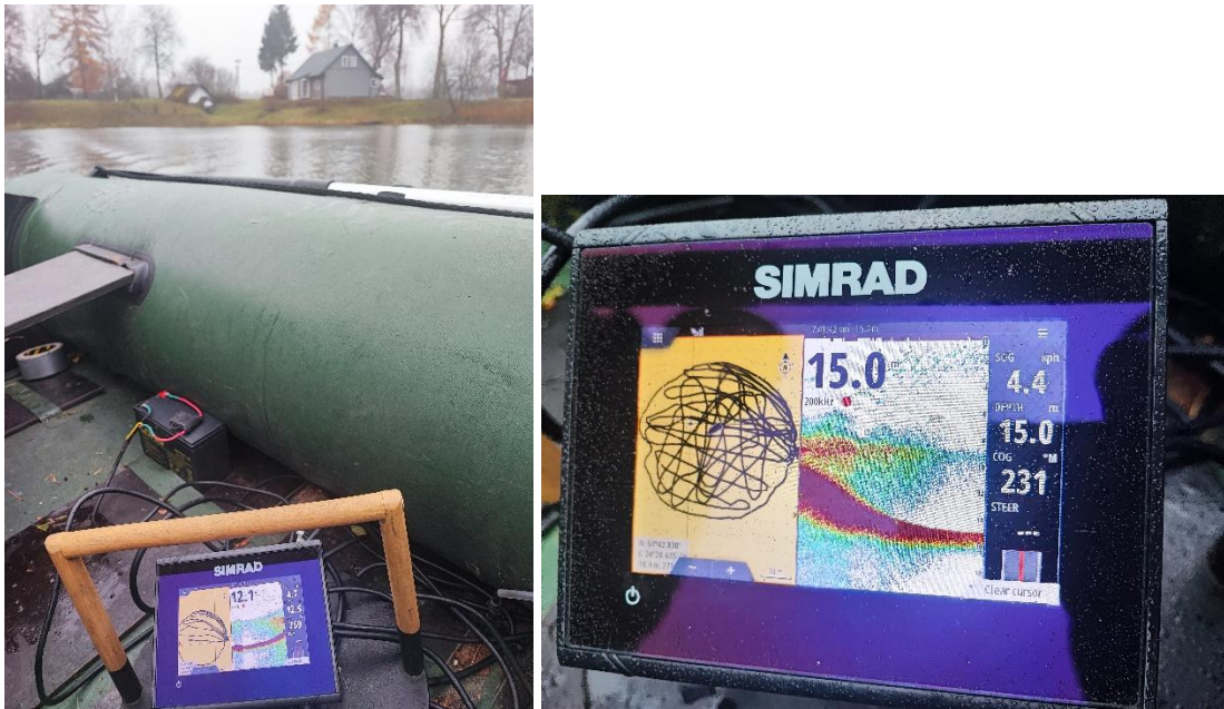
8 pav. Momentinių dugno skenavimo echolotas SIMRAD fiksacijų iliustracijos: užfiksuota giliausia vieta ir povandeninio šlaito nuolydžiai
