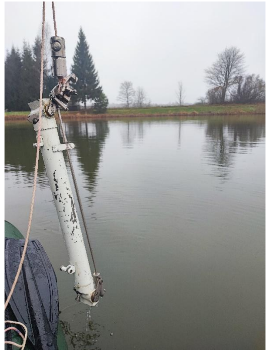
9 pav. Kaukinės ež. vidurys, vandens mėginių ėmimas su botometru iš 10 ir 14 m gylio.
