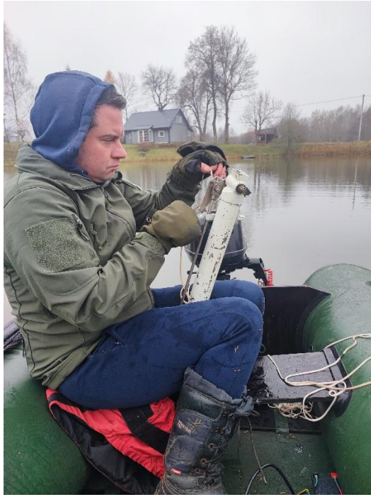
9 pav. Kaukinės ež. vidurys, vandens mėginių ėmimas su botometru iš 10 ir 14 m gylio.
